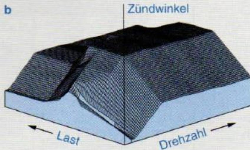
a Zündwinkelkennfeld Last (relative Luftfüllung) und Drehzahl bei (voll) elektronischer Zündung, b Zündwinkelverstellung bei konventioneller Spulenzündung
